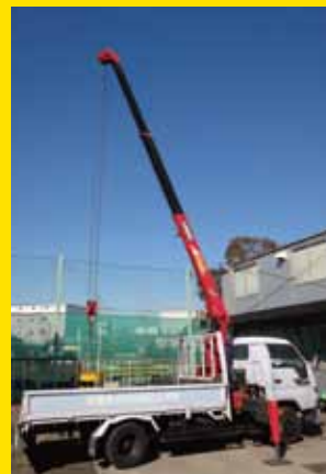
● 小型移動式クレーン
